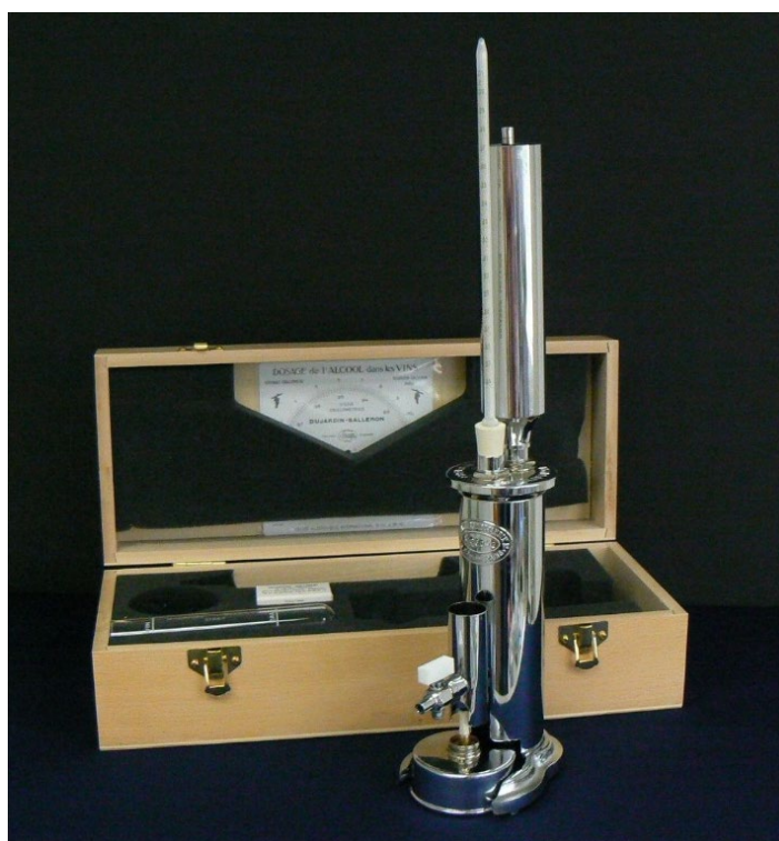
ภาพที่ 4.15 เครื่องวัดปริมาณแอลกอฮอล์ (Ebulliometer)
